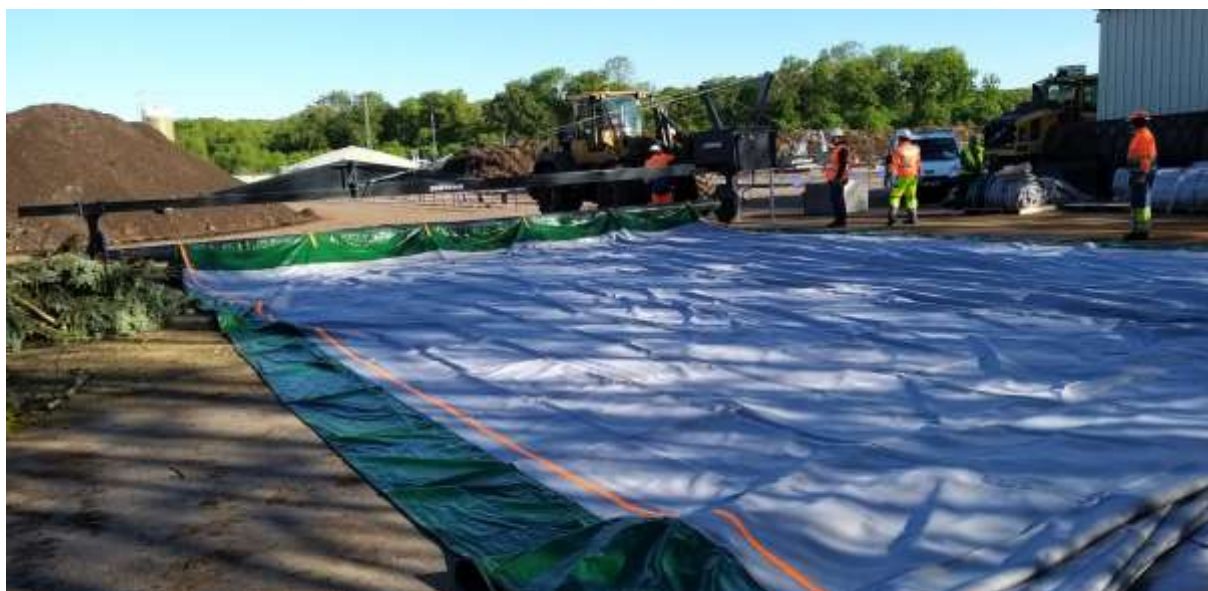
Слика 12. и 13. Пример управљања компоста са биомембрананама
